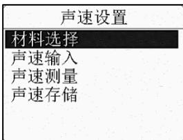
在此选项中，仪器预存了 9 种较为常用的材料声速值，可直接选用；或输入已知声速。用户也可通过声速测量未知材料的声速。
