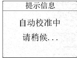
**注：本机开机自动校准，请使用原厂探头。若使用其它探头，仪器无法工作并显示“错误。”**
