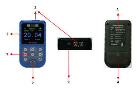
①液晶屏 ②探头插座、识别插针③仪器标牌(背面) ④电池仓(背面) ⑤校准试块 ⑥USB 接口 ⑦键盘
